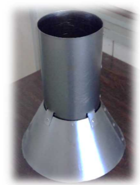
板金加工といって鉄板を曲げて丸い円柱にしています。
