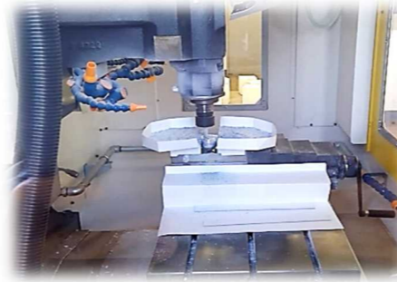
NCフライスを使った加工実習です。自動で切断しています。
