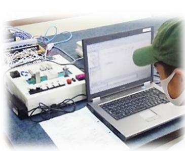
プログラマブル・ロジック・コントローラ (PLC) と検定盤の実習装置
