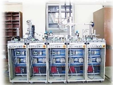
モジュラー・プロダクション・システム (MPS) 実習装置
