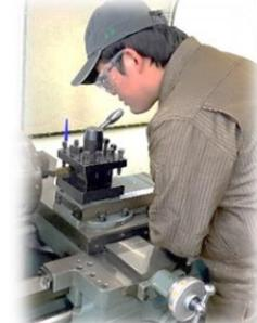
旋盤という工作機械を使用して、鉄の丸い棒を削っています。
